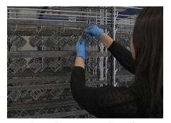
Die Teile werden vorgängig der Lackierung abgedeckt und vorgehängt.
